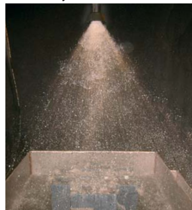
Kontroll av vannskjerm av BROEN dusjhode i test rom:
